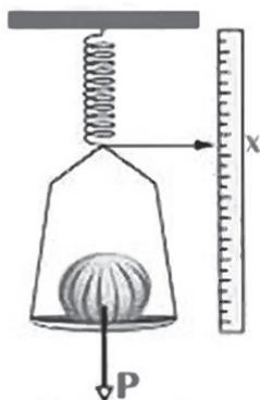
A partir de considerar la proporcionalidad entre el peso de un objeto que se suspende y la longitud del estiramiento del resorte, se construyó un instrumento que mide pesos, se denomina dinamómetro. Consiste en una escala en la que figuran los pesos de los objetos que se suspenden, es decir, se considera como variable dependiente la longitud del estiramiento y como variable independiente el peso del cuerpo.
